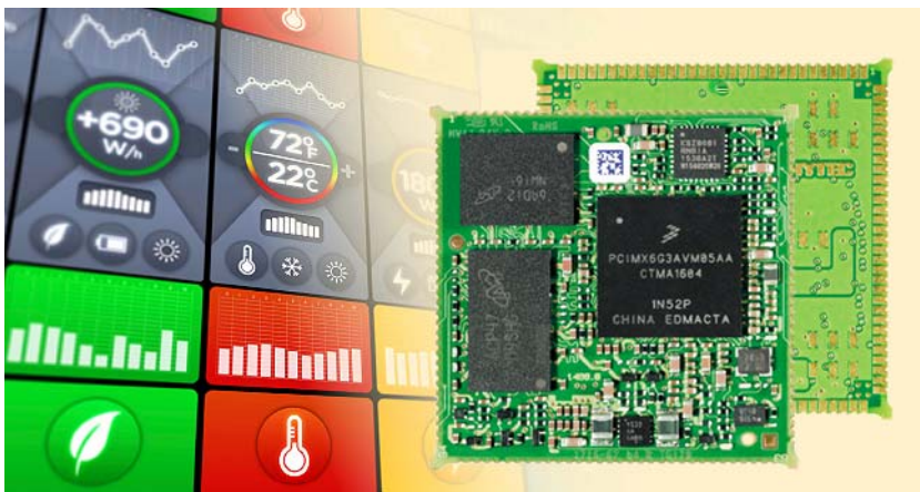
Bild: Ober- und Unterseite vom phyCORE-i.MX6 UL Modul
