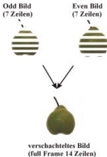
Bild 28: Entstehung des Vollbildes aus zwei Halbbildern mit je 7 Zeilen
