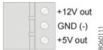
Bild 12: Belegung des Spannungsversorgungsausgangs X302
